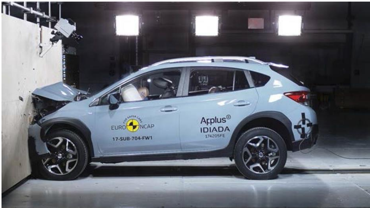
Impatto della Subaru XV (specifiche europee) durante il test Euro NCAP
